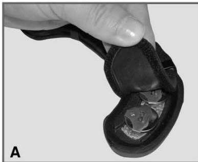
A マジックテープ付のフタで ボタン電池(付属の CR2032) の交換も簡単
